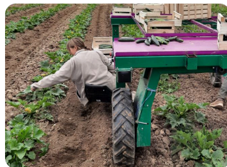
Sièges pivotants, entre les rangs pour la récolte
